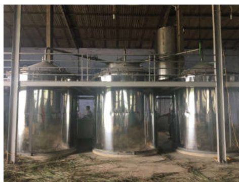
Hệ thống chưng cất tinh dầu bằng hơi nước và áp lực (Essential oil distiller system by steam and pressure)
